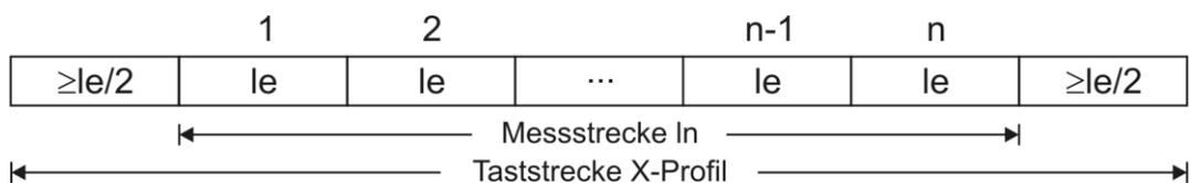
Bild 2: Zusammenhang zwischen Einzelmessstrecke, Messstrecke und Taststrecke.
